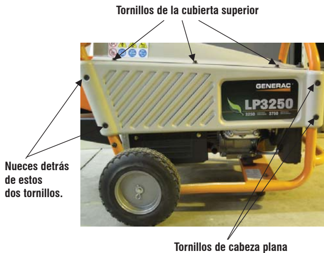
Figura 13 - Retiro de los tornillos
