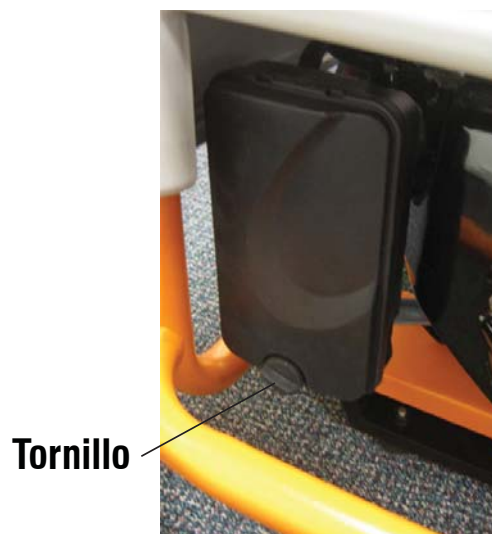
Figura 16 - Filtro de aire
